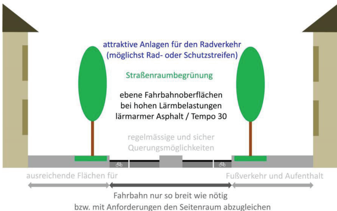
Abb. 35 idealtypischer Straßenquerschnitt im Sinne der Lärminderung
