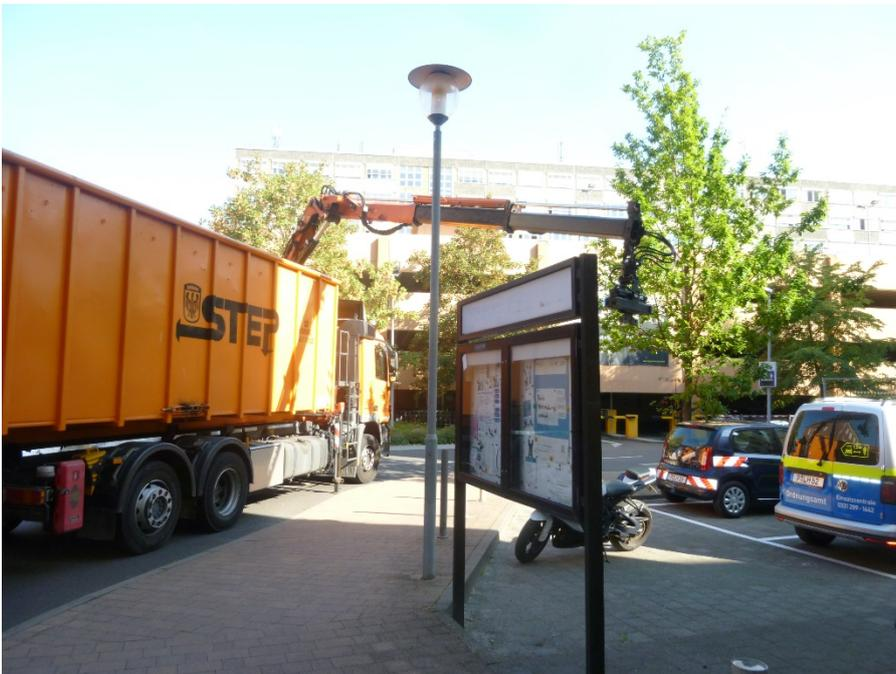
Die Aufstellungsfläche befindet sich außerhalb des möglichen Einsatzes des Hakenliftes. Er würde aufgrund des weiten Abstandes und der damit verbundenen Lastenverteilung beim Anheben der Altglascontainer blockieren. Eine Entleerung wäre nicht möglich.
