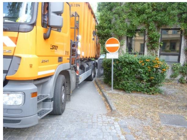
Bei der Ausfahrt wird der Bordstein vom Sammelfahrzeug befahren. Wie auf den Bildern ersichtlich, ist die Ausfahrt nicht breit genug für das Sammelfahrzeug.
