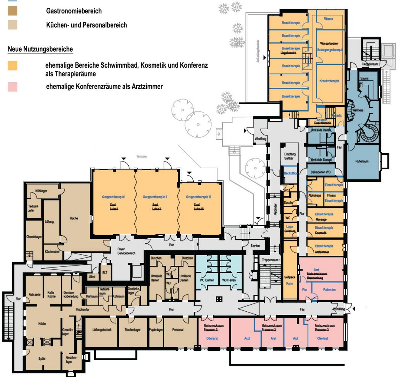
**Abbildung 2: Darstellung der baulichen Umgestaltung im Untergeschoss Haus 1 und 2**
