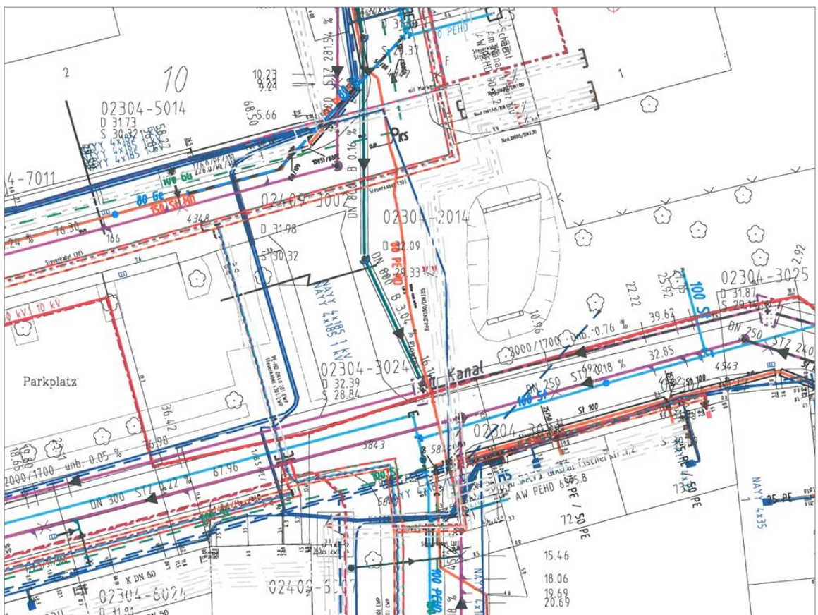
24 Den Stadtkanal querende Leitungen im Bereich der Kellertorbrücke, Mitte rechts die erste Freilegung von 1990
