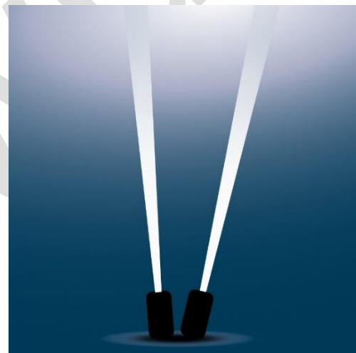
Abbildung 3: Uplights und Sky-Beamer tragen zur direkten Himmelsaufhellung bei (Philipp Thiele)
