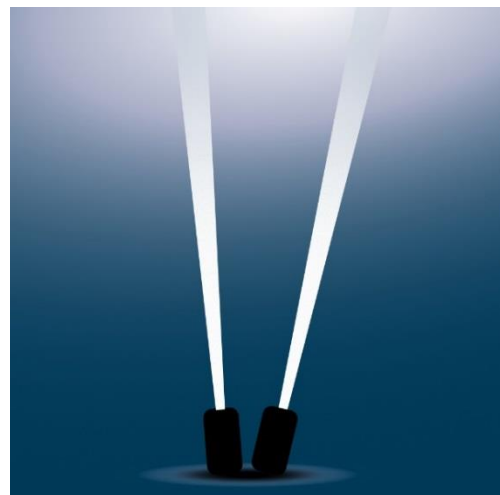
Abbildung 3: Uplights und Sky-Beamer tragen zur direkten Himmelaufhellung bei (Philipp Thiele)
