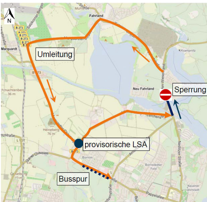
ABBILDUNG 5: VERKEHRSFÜHRUNG WÄHREND DES BAUS DER STRAßENBAHNVERLÄNGERUNG IN DEN POTSDAMER NORDEN (BEISPIEL FÜR DIE BAUPHASE 2 IM ABSCHNITT: INSEL NEU FAHRLAND)
