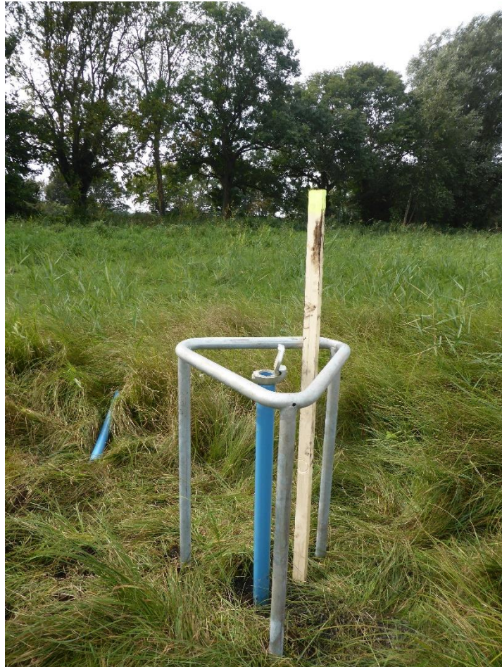
Abbildung 5: Grundwassermessstelle im Polder Fahrland. (Foto: Dr. Kristina Brust)
