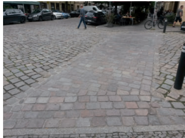
Beispiel für Querung mit eingeebnetem Belag
