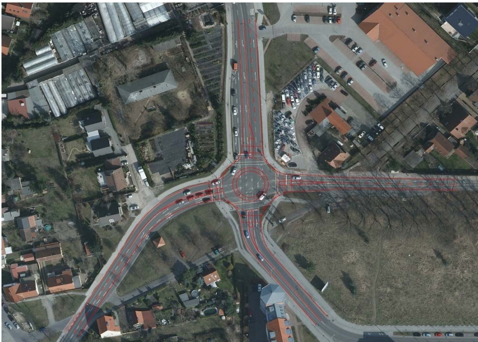
Abb. 34 Lageplanskizze des Knotenpunktes Zum Kirchsteigfeld/Sternstraße mit einem kleinen Kreisverkehr
