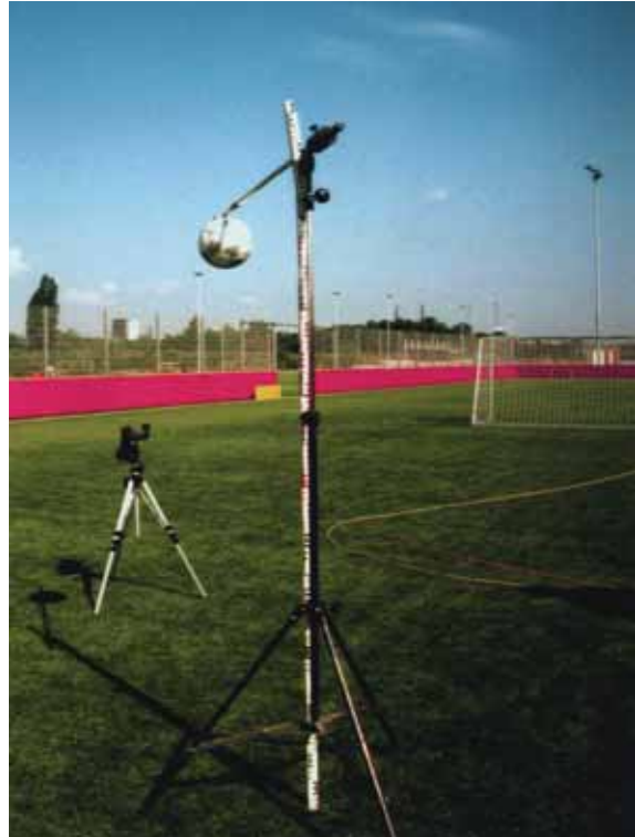
Abb. 6: Messgerät vertikales Ballsprungverhalten Abb. 7: Messgerät Drehwiderstand
