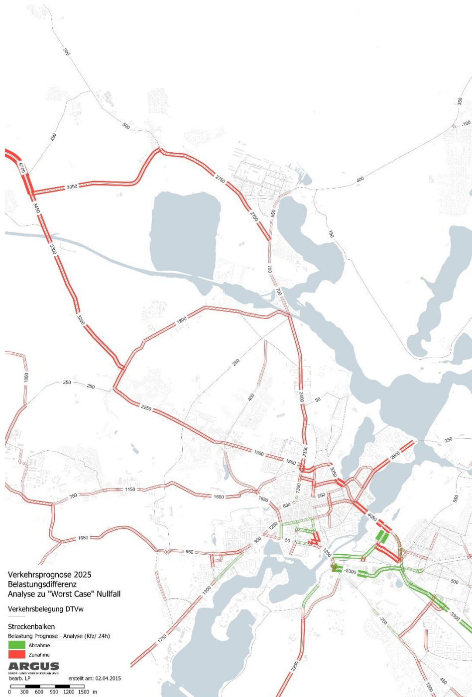
Abbildung 12: Belastungsdifferenz zwischen 2010 und dem „Worst Case“ Nullfall (2025)
