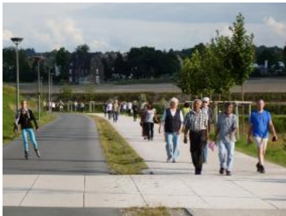
Abb. 38: Trennung durch Zwischenstreifen
